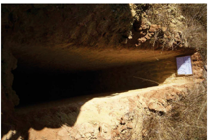
CATA 1 - DETALLE DE EXCAVACION.
