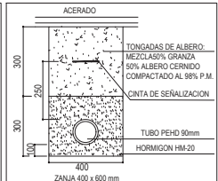
CANALIZACION 1 TUBO BAJO ACERADO
